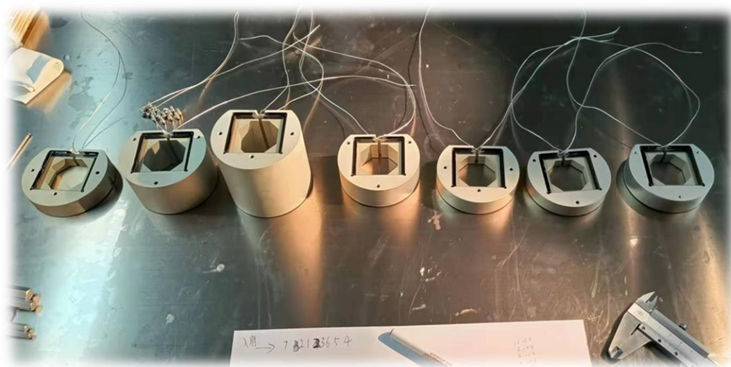
图 5.16 7 级液晶滤光器各单级实物
